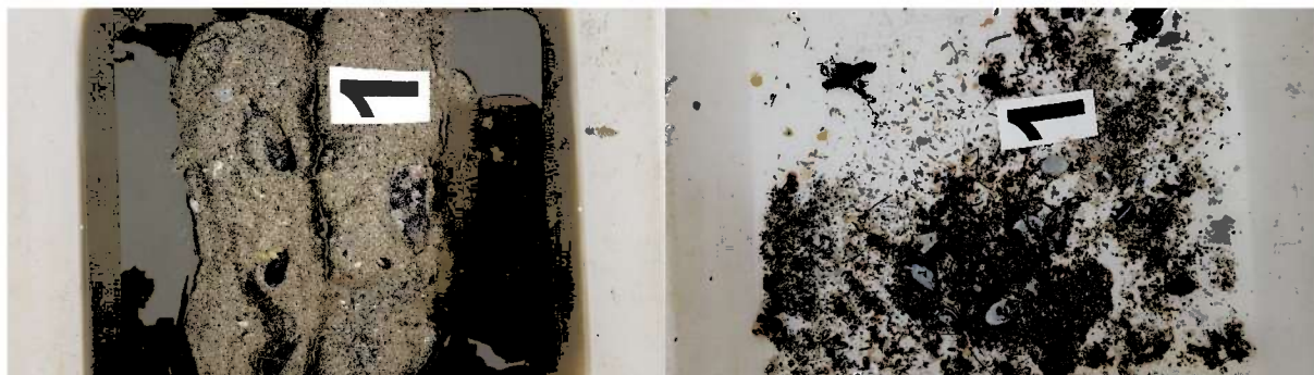
Figur 6: Bilder som viser sedimentet fra stasjon 1 før og etter siling. Sedimentet besto av silt, sand og grus. Foto: Aqua Kompetanse AS.
